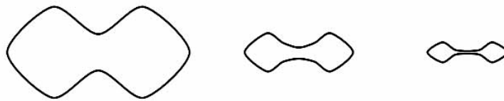
Рис. 5. Пример r_2 \ll r_1, r_3 с разрушающейся шейей (отщипывается) [11]
